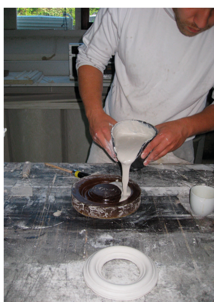
Loftrøset støbes i kunstgummiform på stukkatorværkstedet.
