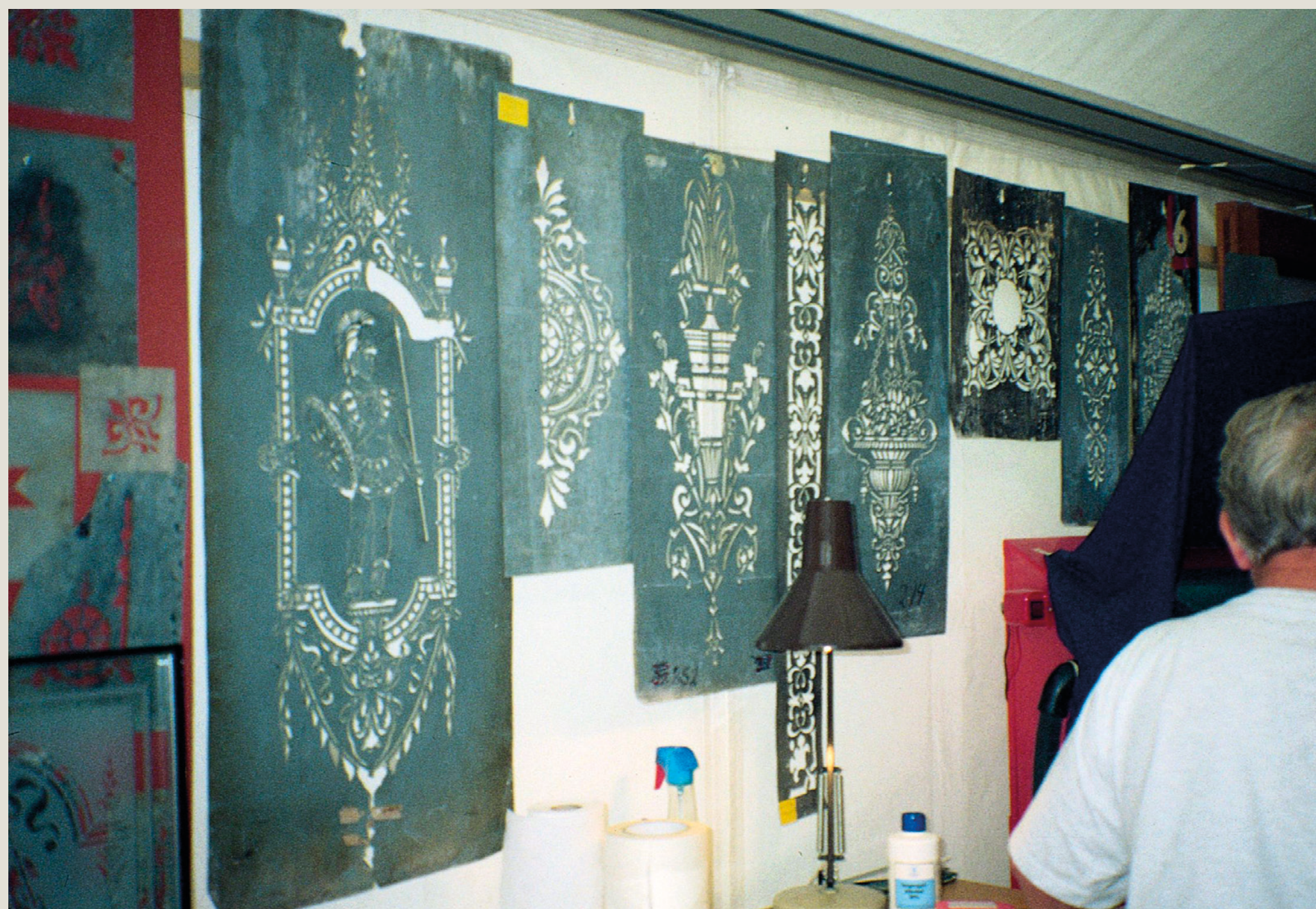
Zinkskabeloner til fremstilling af sandblæste dekorationer på glas og spejle.
