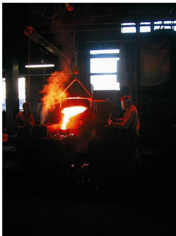
Smeltet støbejern hældes ned i en sandform
