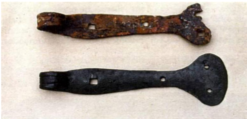
Øverst et rusttæret dørhængsel. Nedenunder det nysmedede beslag.
