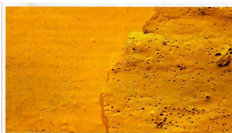
Mikroskopisk bild av ytan på ett färgskikt med alkyd- respektive akrylfärg.
