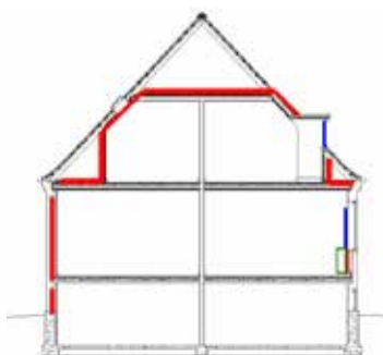
Isoleringen af loftrummet med almindelig mineraluld og et velbevaret understrøget tag
