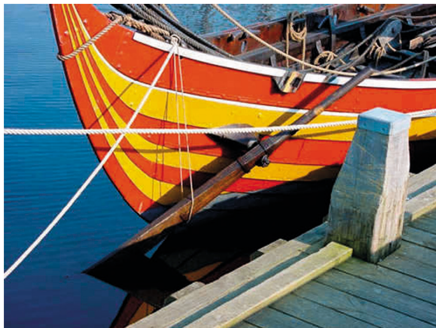
Vikingskibskopien Helge Ask fra Roskilde er malet udvendigt med kaseintemperafarver. Farverne er autentiske og har en formidabel holdbarhed i forhold til moderne malingstyper. Foto: Søren Vadstrup.
